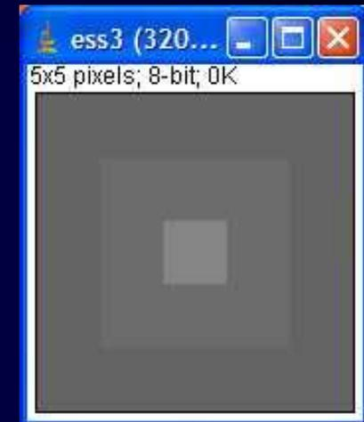
👉 Le résultat d'un tel filtrage est un lissage de l'image, il s'agit d'un **filtre passe-bas**.
